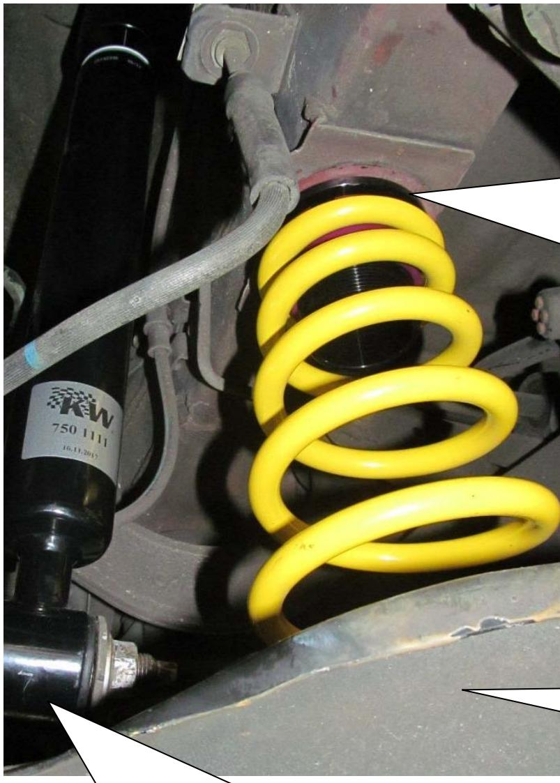
Die HA-Verstellung wird oben zwischen Feder und Karosserie montiert. Die serienmäßige Federunterlage entfällt. Zum Korrigieren (verdrehen des Gewinderings) der Fahrzeughöhe, ist die HA-Verstellung aus dem Fahrzeug zu demontieren. Achtung: Vor dem Einsetzen der Höhenverstellung müssen die Berührungsflächen gereinigt werden.
