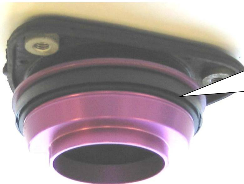
Original Axiallager von dem serienmäßigen Stützlager entnehmen. Mitgelieferten Axiallagersatz in folgender Reihenfolge auf das Stützlager setzen: Serienstützlager; Kunststoffscheibe; Axiallager; Federteller.
