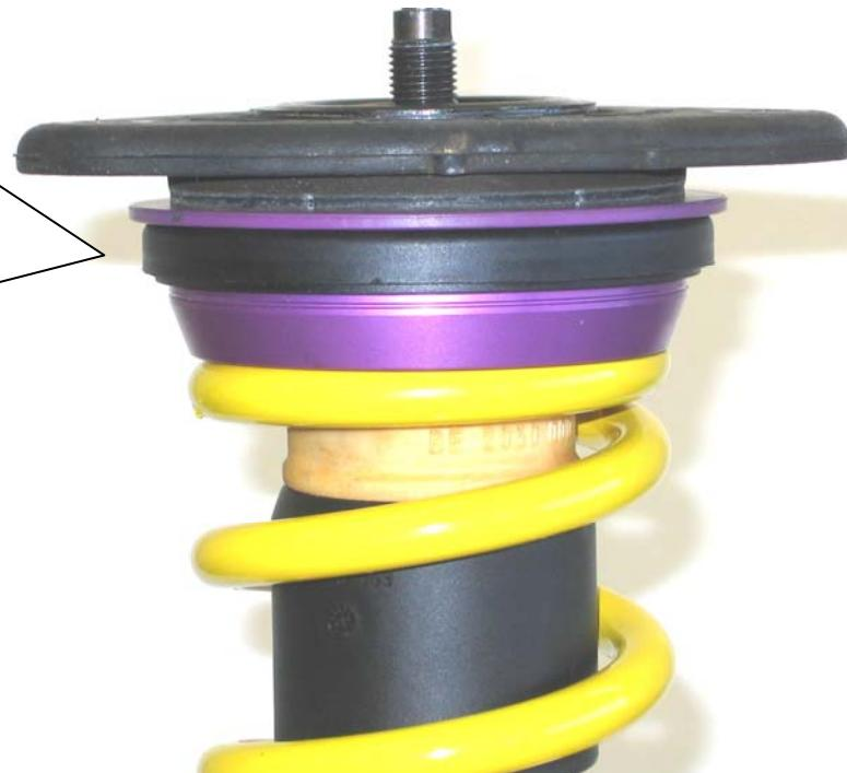
Die vormontierte Stützlagereinheit auf das Federbein aufsetzen, und mit der mitgelieferten Stoppmutter verschrauben. Das Anzugsdrehmoment der Kolbenstangenbefestigung beträgt 35 Nm. Die Montagehinweise zum Einbau des Federbeins in das Fahrzeug, sowie die Anzugsdrehmomente der Federbeinbefestigung, entnehmen Sie bitte den Unterlagen des Fahrzeugherstellers.
